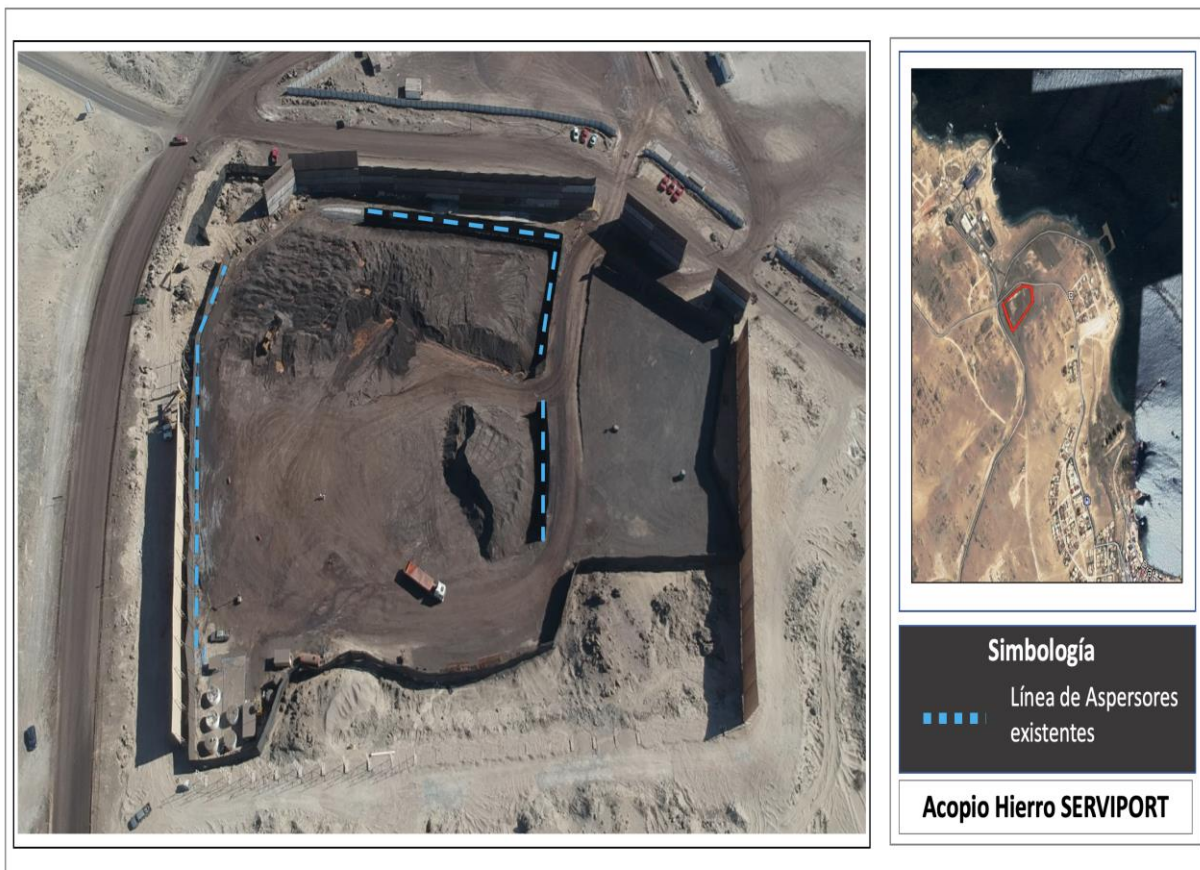
Imagen 6. Sistema de Aspersores Existentes
